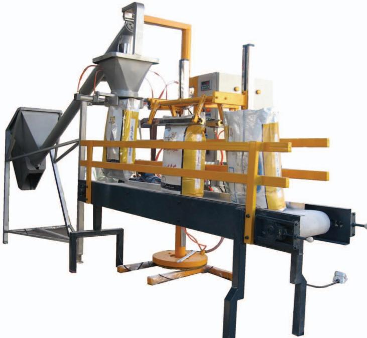
■ دستگاه انتقال دهنده کمپوست از سیلوی اصلی به مخزن ورودی جهت تغذیه اتوماتیک ترازوها با کنترل های مربوطه با سیستم آگر ( ماردونی ) توضیح اینکه در صورت عدم وجود سیلوی اصلی ورودی ماردون دارای مخزن جهت ریختن دستی کمپوست می باشد.
