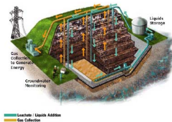
شکل ۳- طراحی شماتیک از بیورآکتور بی هوازی
