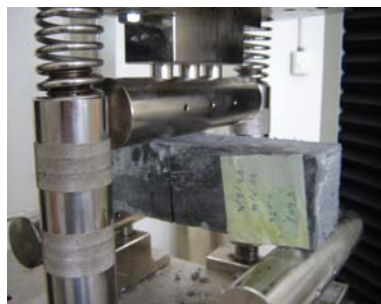
شکل ۲-۷ الف و ب: شکست خمشی نمونه های کامپوزیت سیمانی حاوی ذرات لاستیک
