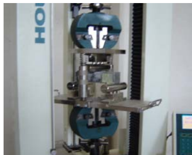
شکل ۲-۷ الف و ب: شکست خمشی نمونه های کامپوزیت سیمانی حاوی ذرات لاستیک
