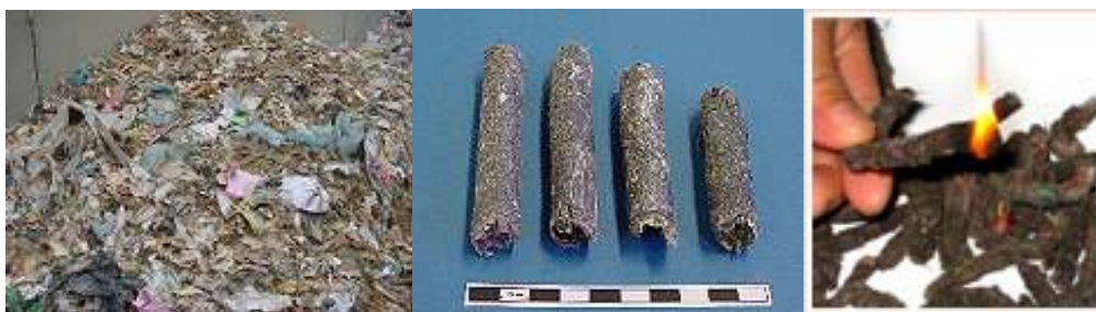
شکل ۵: نمونه‌ای از RDF زباله و اشتعال پذیری آن [۲]
